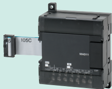
CP1W-MAD11型 類比輸入：2點 (解析度：6,000) 類比輸出：1點 (解析度：6,000)
