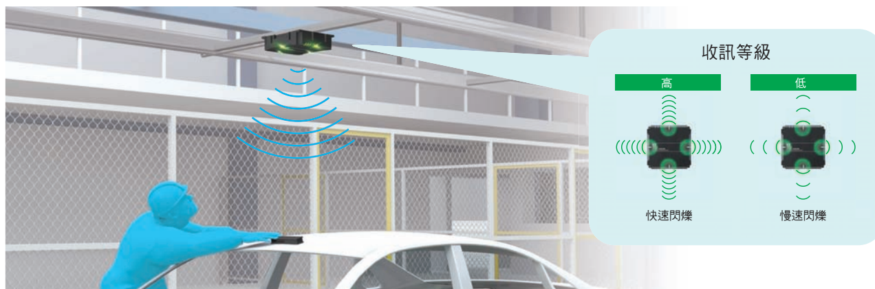
目視確認讀寫器的LED以調整RF標籤的安裝位置，提高收訊等級
