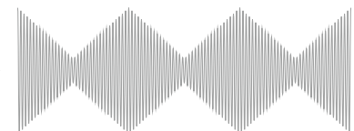
變頻器2次側漏電電流波形示意圖 電流值反覆增減。
