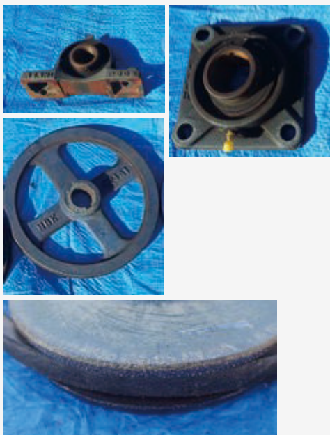
皮帶與滑輪已因摩擦而磨損。
