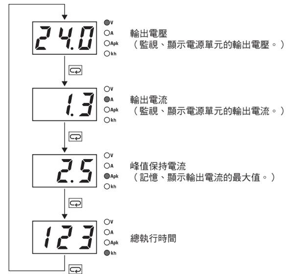
註1. 峰值保持電流將於電源起動3秒後開始測量，因此無法測量負載的突波電流。
